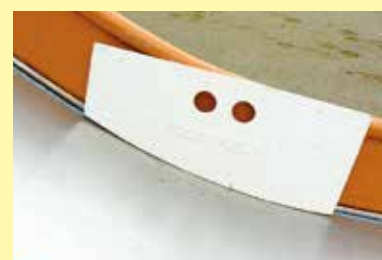
滑台の傾斜変化部の曲率半径750mm以上に適合しているか、また同時に、側板高さが確保されているかを計測
