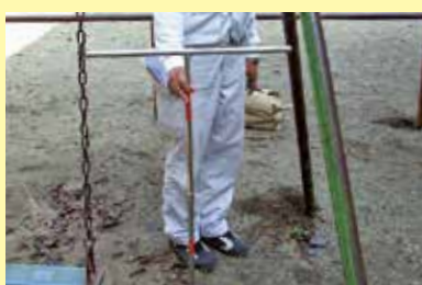
ブランコの吊り部材と支柱部との間隔(着地面から+1000mmの位置)650mm以上が確保されているかを計測
