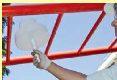
子供の頭部230mmφを想定した器具で挟み込みについて適合しているかを計測
