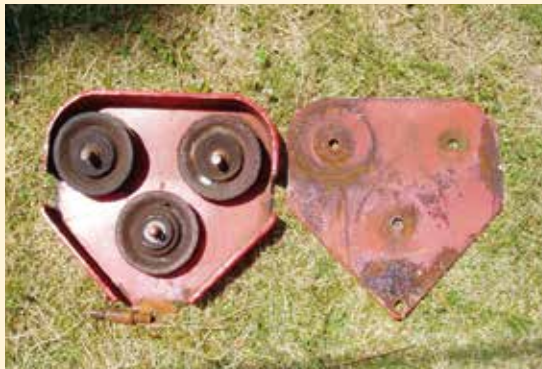
外観からは程度が判らなかったボックス内の状態。滑車部の磨耗や腐食が進行していた事が判明
