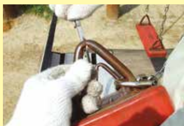
ノギスを使用し、金具とチェーンの磨耗を計測し劣化状態を診断
