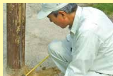
遊具を点検ハンマーで軽打して異音の有無を判断し、劣化状態を診断
